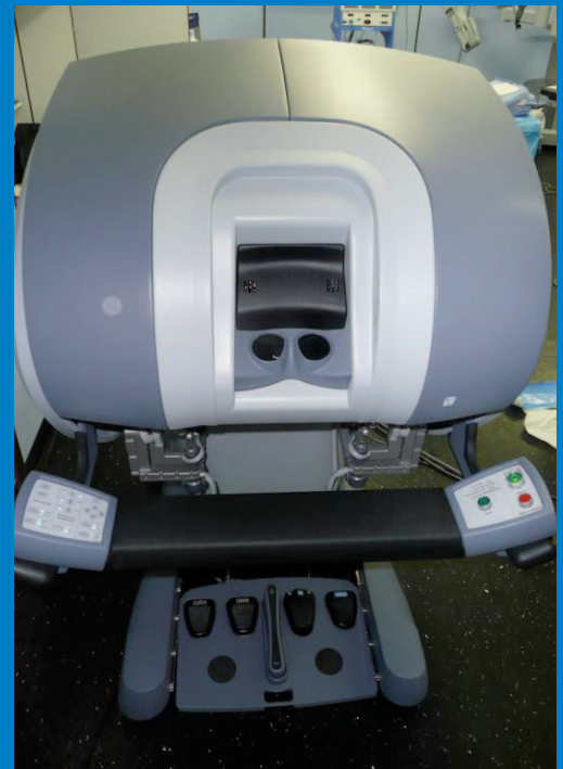
Console de commande : vision binoculaire en 3D, manettes et pédales
